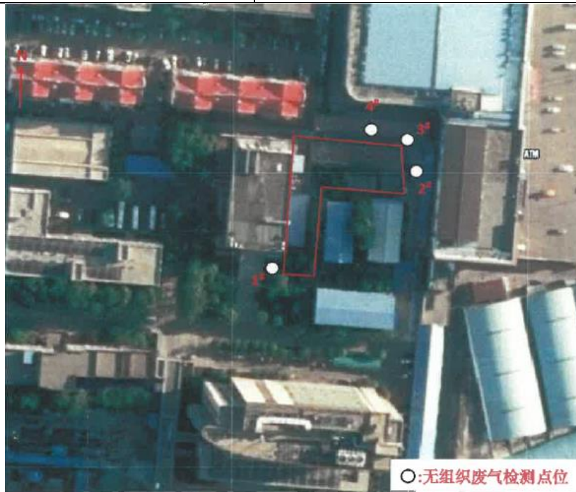
污水处理站无组织废气检测点位图(2021.6.02)
