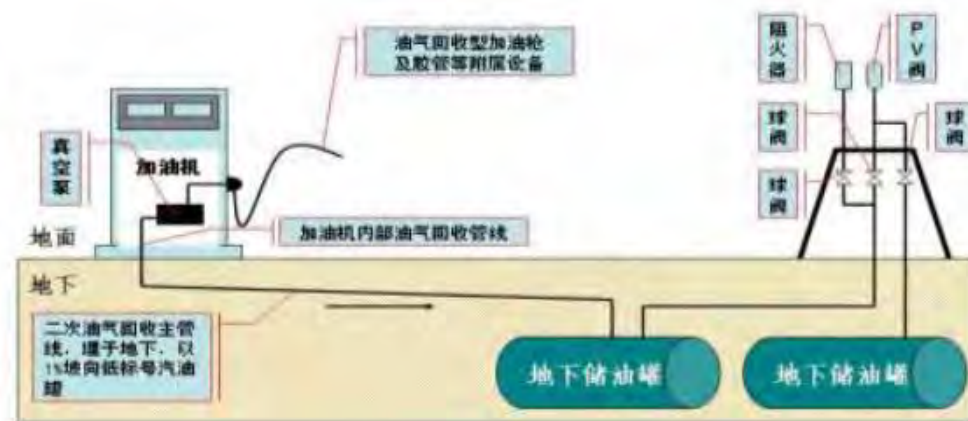
二次油气回收工艺流程简图
