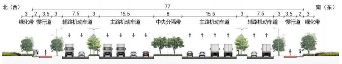
图8 地面快速路标准横断面图
