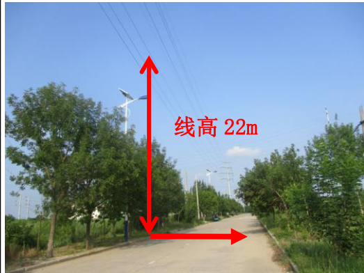
图 7-2 110kV 湖园/110kV 湖余线 3#-4#线南衰减断面
