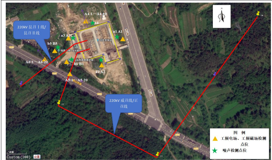
图 4-11 变电站、输电线路路径及检测布点布置示意图
